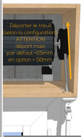
11 Insérer le passe caisson dans le treuil, scier la tige d'attaque si celle-ci est trop longue et fixer le passe caisson sur la sous face du coffre existant.
