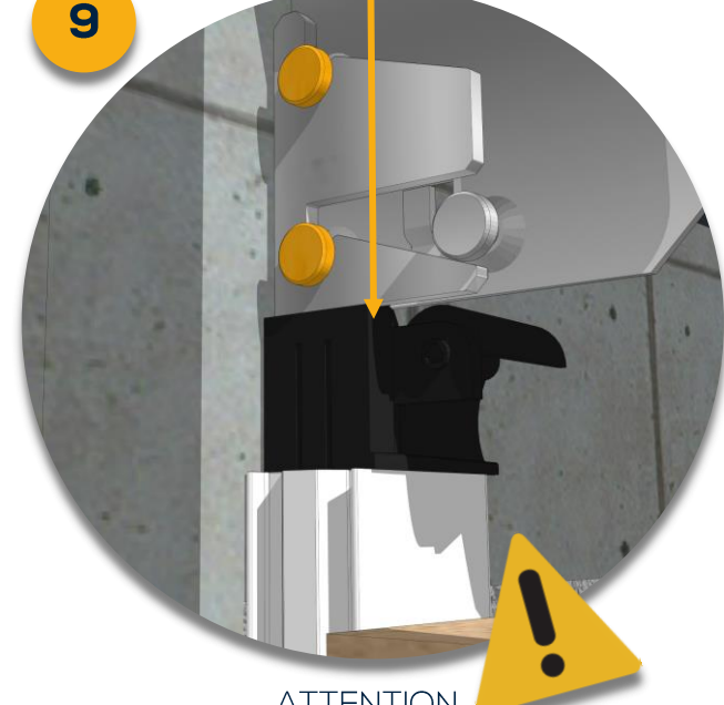
9 ATTENTION, les plots des équerres et/ou des flasques doivent être correctement insérés sur les pattes.
