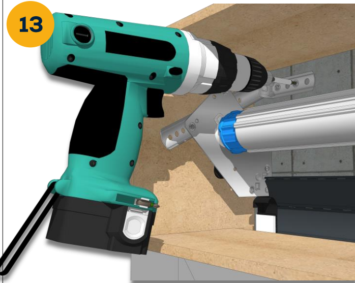
13 Reprendre les jambes de force sur le linteau, (ou sur le coffre selon configuration de pose).
