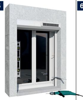
Contrôler les niveaux ainsi que l'équerrage et marquer l'emplacement des perçages si-nécessaire.
