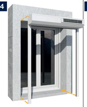
Insérer le coffre dans le tableau celui-ci ne doit pas rentrer en force (pose tableau).
