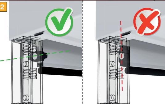
Contrôler le bon positionnement des butées escamotables. Celles-ci doivent être vérouillées en position horizontales.
