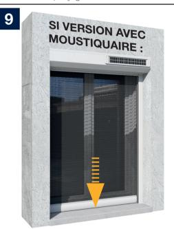
Tester la fermeture de la moustiquaire. Que la lame finale se verrouille correctement dans les butées basses.
