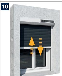
Faire à 1 cycle de manière à contrôler que le tablier monte et descend correctement dans les coulisses.
