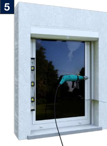
Perçer le mur (selon la nature de celui-ci, brique, parpaing, enduit... et des fixations utilisées), prendre les précautions nécessaires afin de ne pas détériorer le produit
