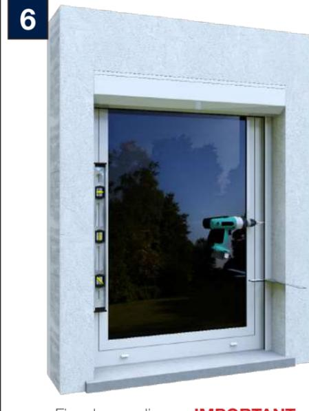
Fixer les coulisses, **IMPORTANT** : le type de fixation et dimensionnement doit être adapté au support, le niveau de protection répondra à la classification de corrosion en rapport à la norme **NF EN 1670**
