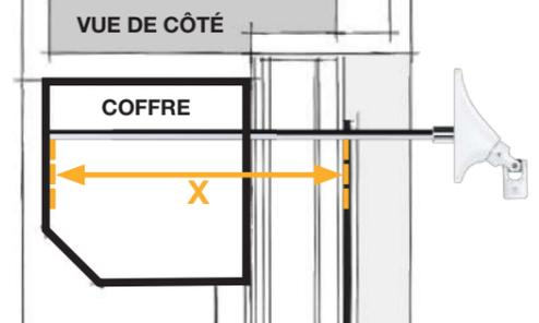
Insérer la tige du renvoi de mouvement dans la menuiserie jusqu'en butée dans le coffre
