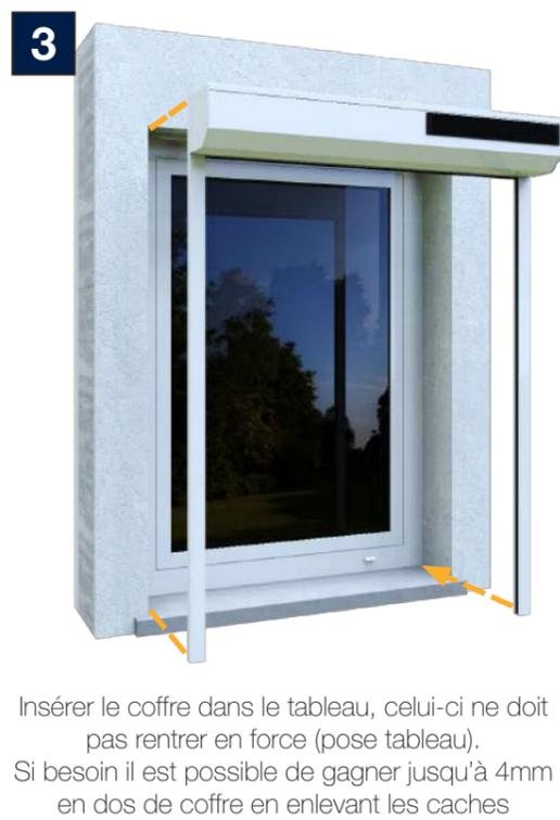
Insérer le coffre dans le tableau, celui-ci ne doit pas rentrer en force (pose tableau). Si besoin il est possible de gagner jusqu'à 4mm en dos de coffre en enlevant les caches
