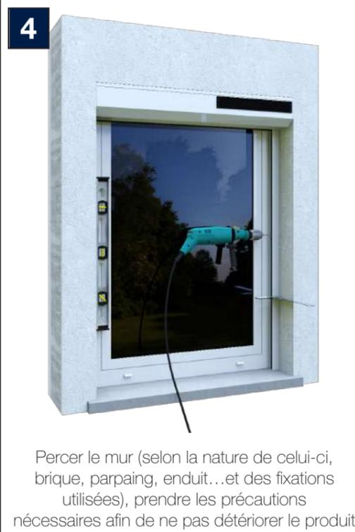
Perçer le mur (selon la nature de celui-ci, brique, parpaing, enduit...et des fixations utilisées), prendre les précautions nécessaires afin de ne pas détériorer le produit
